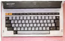
La scartata del PC-3000 assomiglia a prima vista a quella di una macchina per scrivere, ma per la presenza di i tasti di funzione e dei tasti speciali, ne rende l'aspetto "computer". Molto agevole la digitazione.
